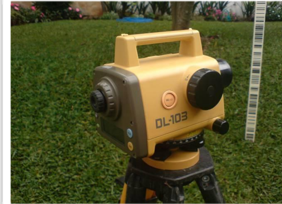
Nivel de precisión electrónico digital Marca Topcon Modelo DL-103. Serie RT 2488
