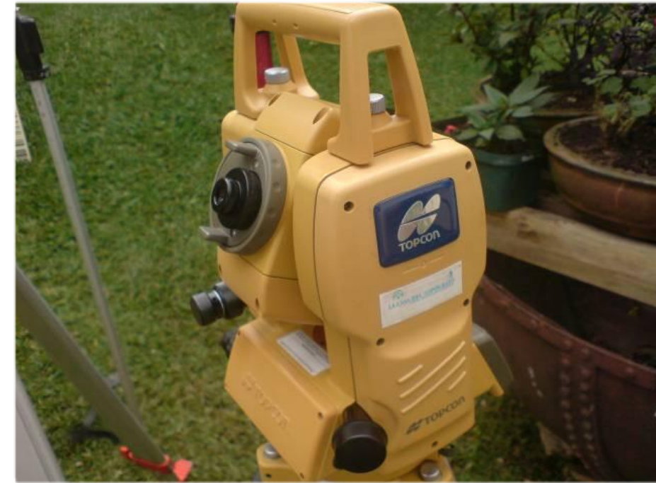
Estación Total Marca Topcon Modelo GTS 236W Serie 280597
