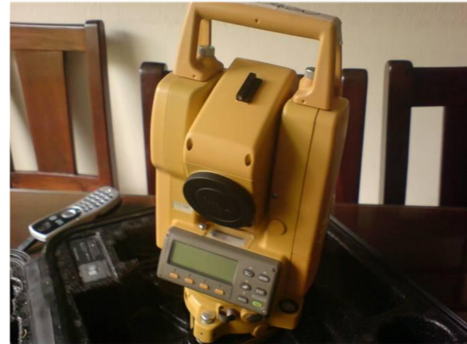
Estación Total Marca Topcon Modelo GTS 226 Serie 6509
