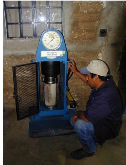
Prensa para cilindros de Concreto Hidráulico
