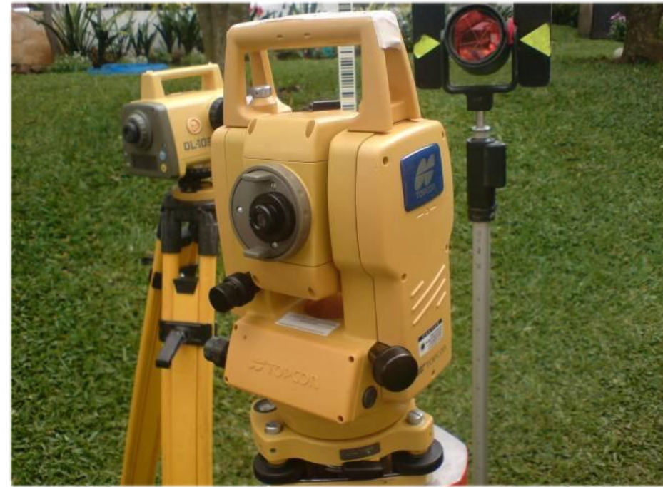
Estación Total Marca Topcon Modelo GTS 236W Serie 280636
